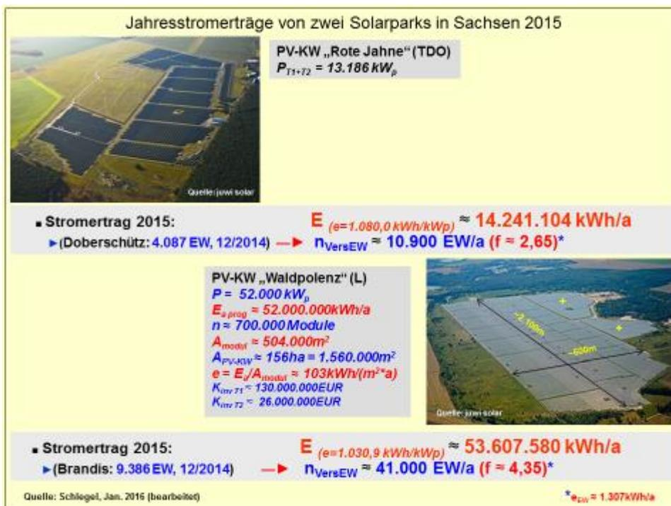
Abb. 12: Jahresstromerträge von zwei ausgewählten PV-Kraftwerken
