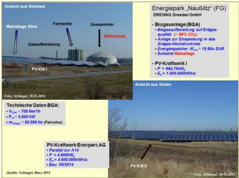
Abb. 13: Jahresstromerträge von zwei ausgewählten PV-Kraftwerken
