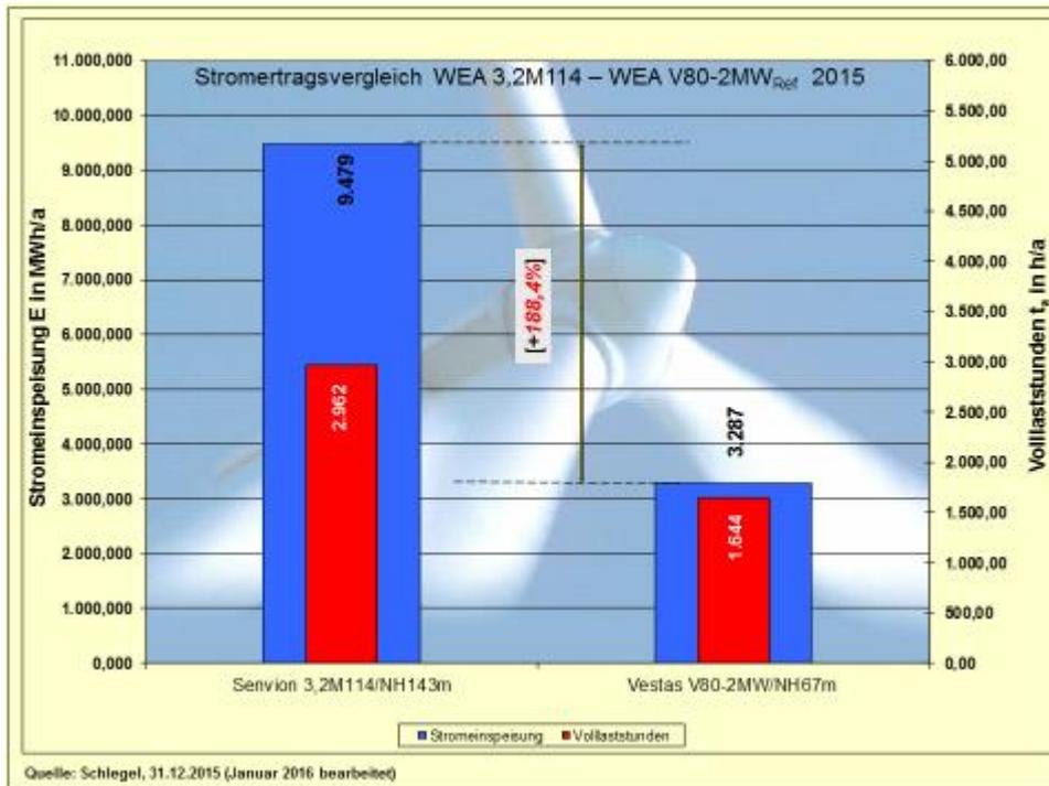
Abb. 9: Stromerträgevergleich der 3-MW-Klasse mit der 2-MW-Referenz-WEA
