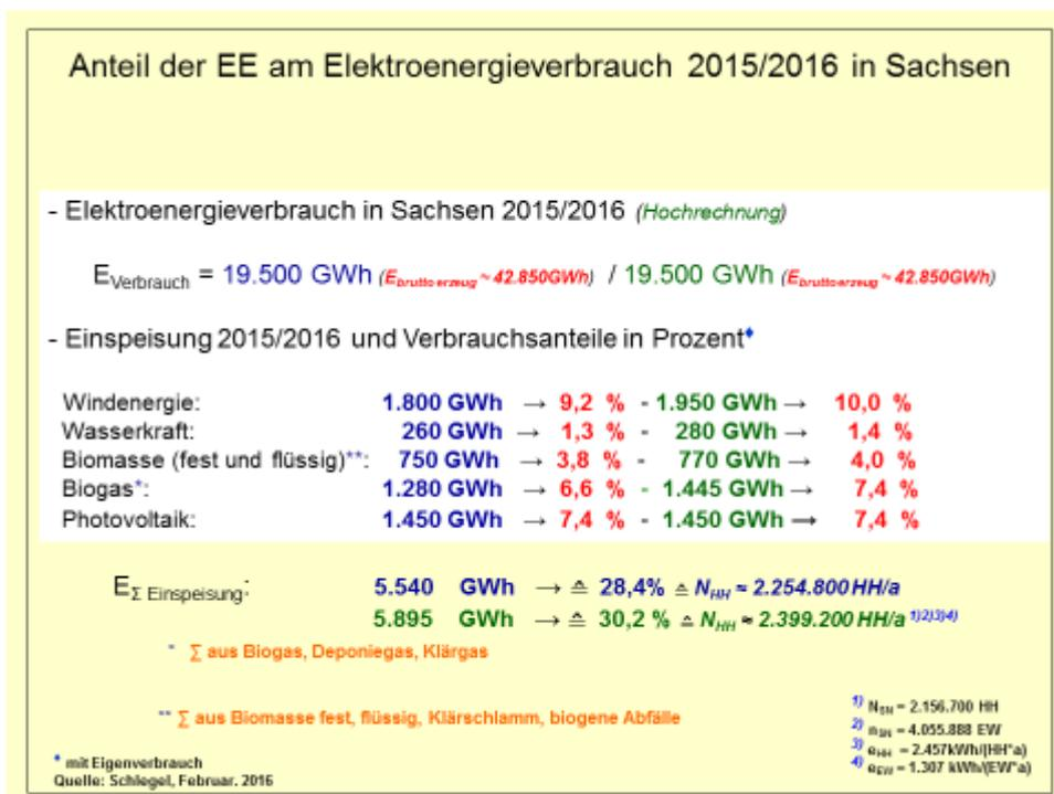
Abb. 6: Anteile der EE-Stromerzeugung 2015/2016 am Verbrauch (Daten nicht ausgewertet)
