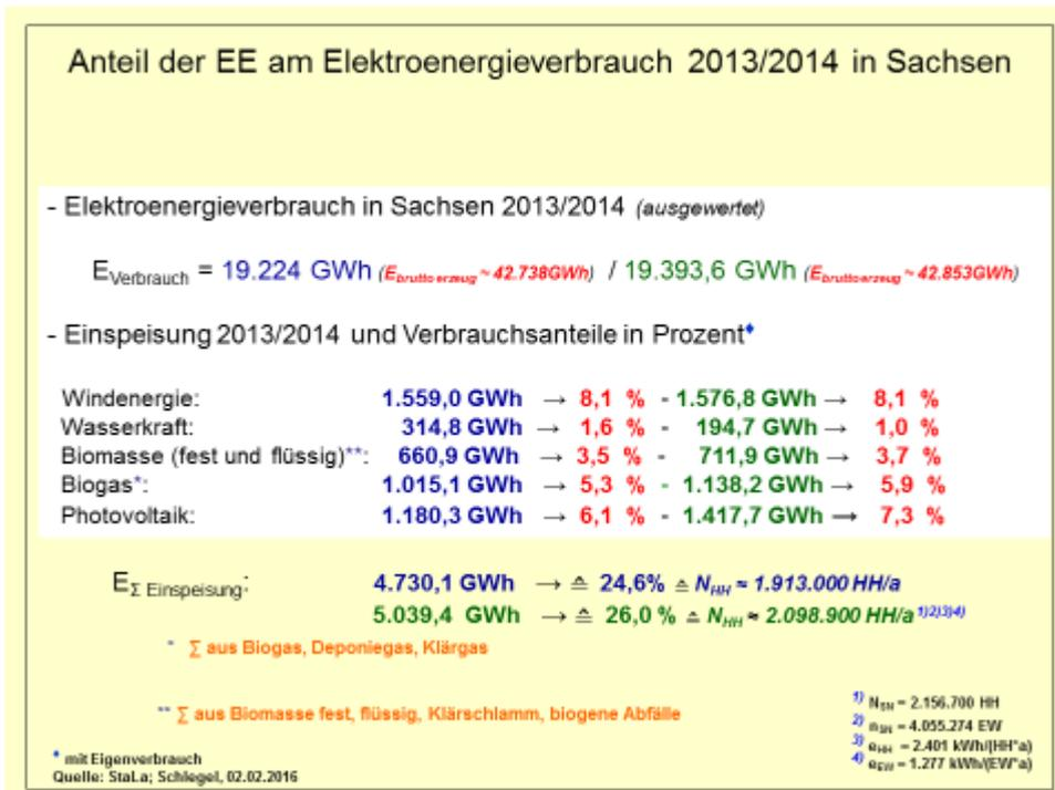
Abb. 4: Anteile der EE-Stromerzeugung 2013/2014 am Stromverbrauch (Daten ausgewertet)
