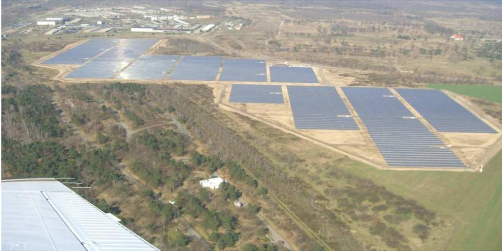
Abb. 3.3-2: PV-Kraftwerk „Zeithain“ (LK. Meißen); P = 12 MW<sub>p</sub>; p-Si-Module
